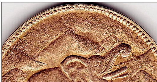
Stempelriss auf der Bildseite bei Typ B
